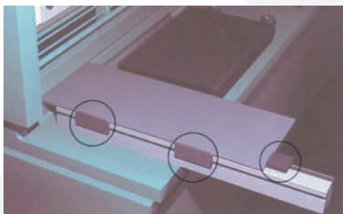
Передний и боковые регулируемые упоры на направляющей
